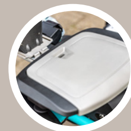
De rijdersstoel is draaibaar om het opstappen te vergemakkelijken (optioneel)
